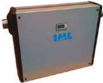
**Descripción del equipo.** Cubeta en acero inoxidable AISI-316. / Resistencias en acero blindadas en INCOLOY 825. / Envoltente en ALUCOIL. / Termostato digital de regulación de temperatura de 0 a 40 °C. / Contactos de maniobra. / Control de depuradora.
