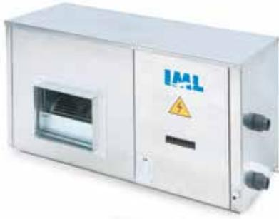
**Descripción del equipo.** Carcasa robusta y ligera en Aluminio al Magnesio anticorrosión. / Ventilador Centrífugo con acoplamiento directo de bajo nivel sonoro. / Compresor rotativo. / Evaporador de Agua formado por envoltorio de PVC y serpentín de TITANIUM G2. Garantizado contra la corrosión. / Gas refrigerante R-407C. / Presostatos de alta y baja presión, flujostato para control de caudal de agua, control de depuradora con contacto libre de tensión y temporizador.
