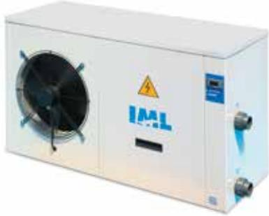
**Descripción del equipo.** Carcasa robusta y ligera en Aluminio al Magnesio anticorrosión. / Compresor rotativo. / Evaporador de Agua formado por envoltente de PVC y serpentín de TITANIUM G2. Garantizado contra la corrosión. / Gas refrigerante R-407C. / Presostatos de alta y baja presión, flujostato para control de caudal de agua, control de depuradora con contacto libre de tensión y temporizador.
