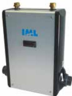
**Descripción del equipo.** Regulador con control de bomba de secundario, con contacto libre de tensión y temporizador. / Envoltorio exterior construida en Alucoil y plástico ABS. / Cuerpo en titanio (secundario, agua piscina). / Serpentin en aleación de titanio (primario, agua de caldera). / Totalmente equipado, válvula antirretorno, bomba de recirculación de primario y termostato de control con sonda de inmersión. / Presión de trabajo primario 10 bar. / Presión de trabajo secundario 3 bar.
